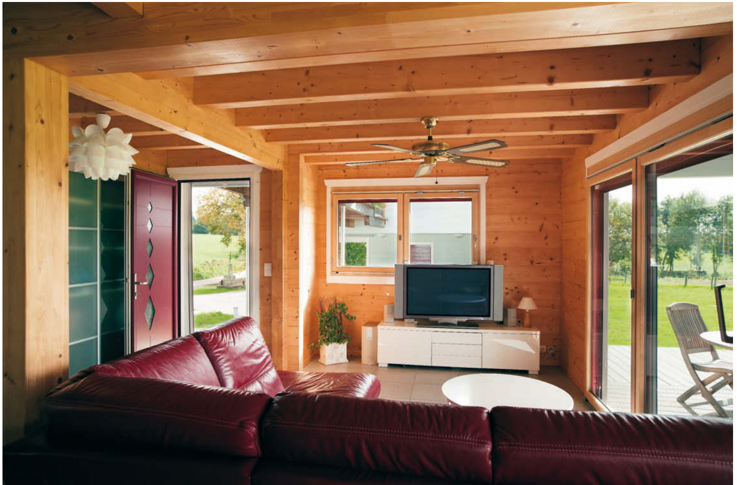
Toutes les ouvertures proviennent de MC France. Réalisées en bois (hêtre) et aluminium, elles sont équipées d'un double vitrage. L'orientation de la maison a été travaillée pour profiter de l'ensoleillement tout au long de la journée. La façade principale fait face au Sud-Ouest.
