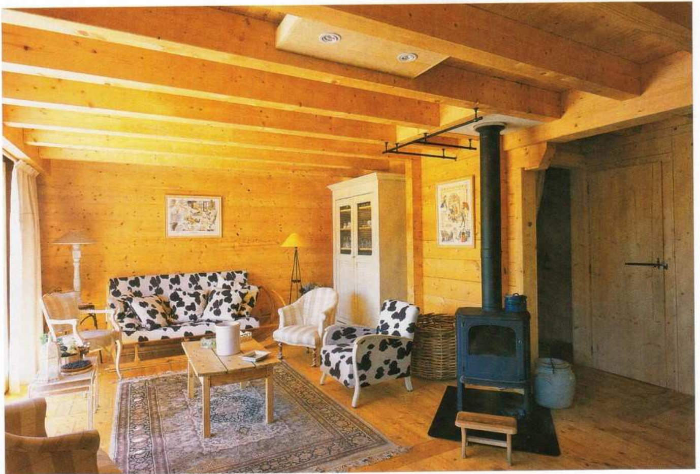
Ce poêle en fonte demeure la source principale de chauffage pour cette habitation de 110 m 2 .
